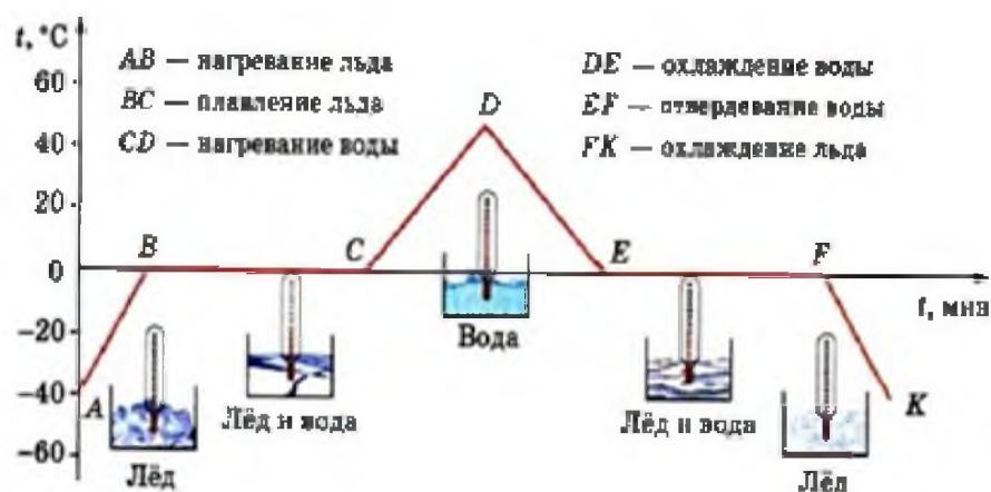
**Рис. 1.** График плавления льда и отвердевания воды
