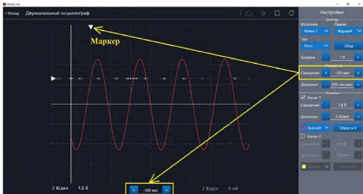
**Рис. 38.** Использование параметра **Смещение** в блоке **Развёртка**
