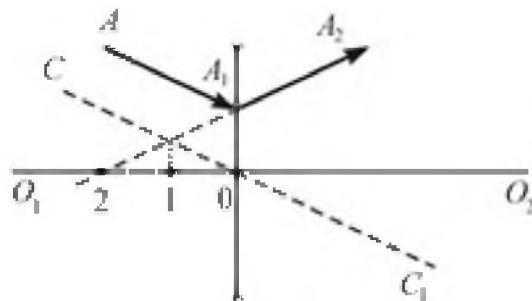
**Рис. 6.** Ход лучей света в тонкой рассеивающей линзе
