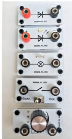
*Рис. 17.* Дополнительные элементы электрических цепей
