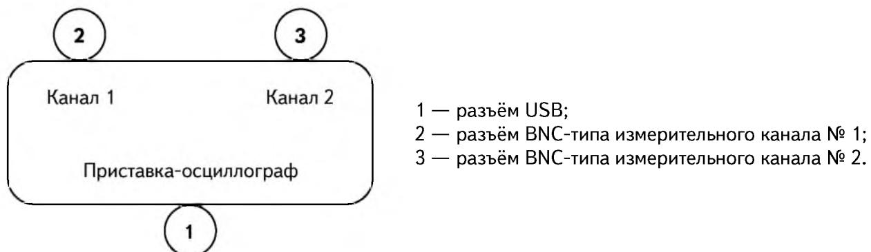
Рис. 33. Схема приставки-осциллографа
