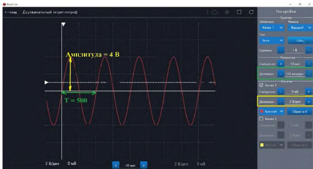
**Рис. 42.** Определение параметров осцилограммы
