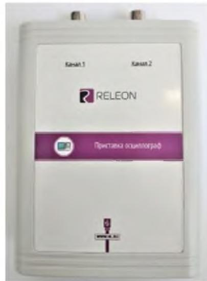
Рис. 32. Двухканальная приставка-осциллограф
