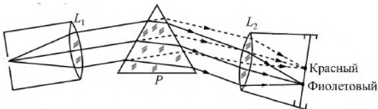
**Рис. 7.** Схема призменного спектрографа
